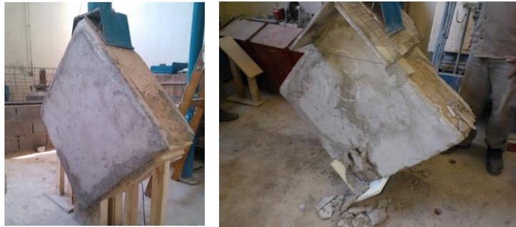
Fig. 11. Ensayos de muretes reforzados con malla electrosoldada y mortero cementicio
