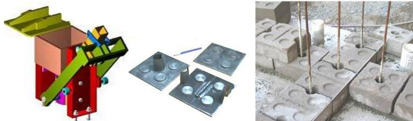
Fig. 3. Prensa IRPHa RAM, Matrices, Contrafuertes con armaduras.
