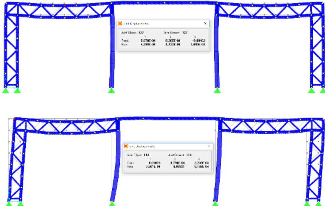
Figura 43. Desplazamientos para cargas gravitatorias (arriba) y para acciones sísmicas (abajo).
