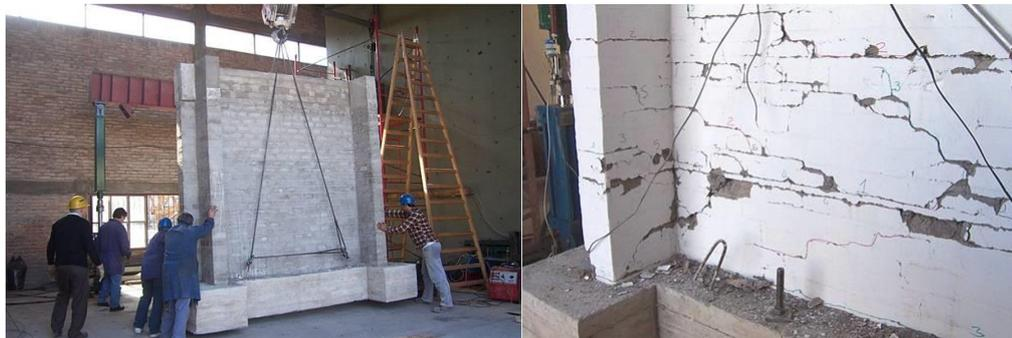
Fig. 4. Enplazamiento del muro de ensayo y patrón de agrietamiento.
