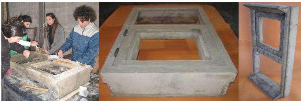
Fig. 9. Ventana de hormigón moldeable “in situ”
