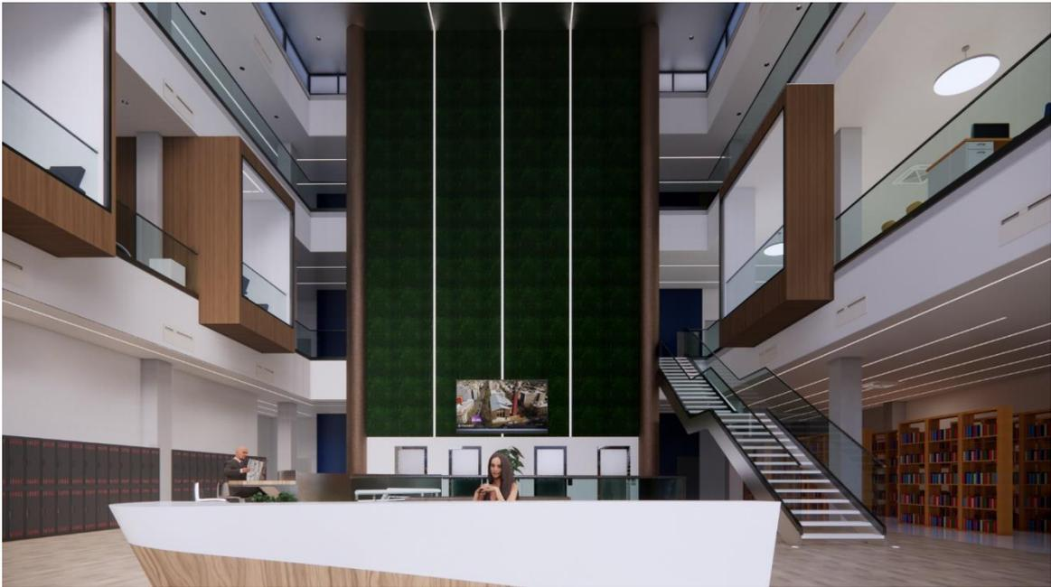
La cubierta del hall se eleva 1,50m respecto del nivel de losa de las alas laterales, esto es para que la luz solar ingrese de manera indirecta al interior para evitar el efecto invernadero, pero a su vez tener una buena iluminación natural (como se observa en la imagen siguiente).
