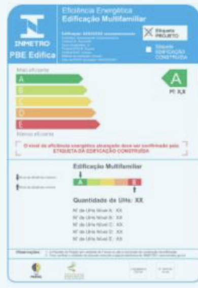
Figura 1.21: Etiqueta Nacional de Conservación de Energía (ENCE) para edificios residenciales multifamiliares de Brasil.
