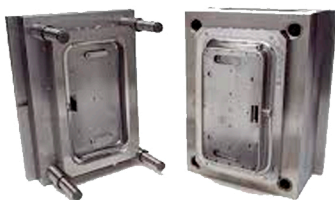
Molde de acero mecanizado para inyección de Polipropileno.
