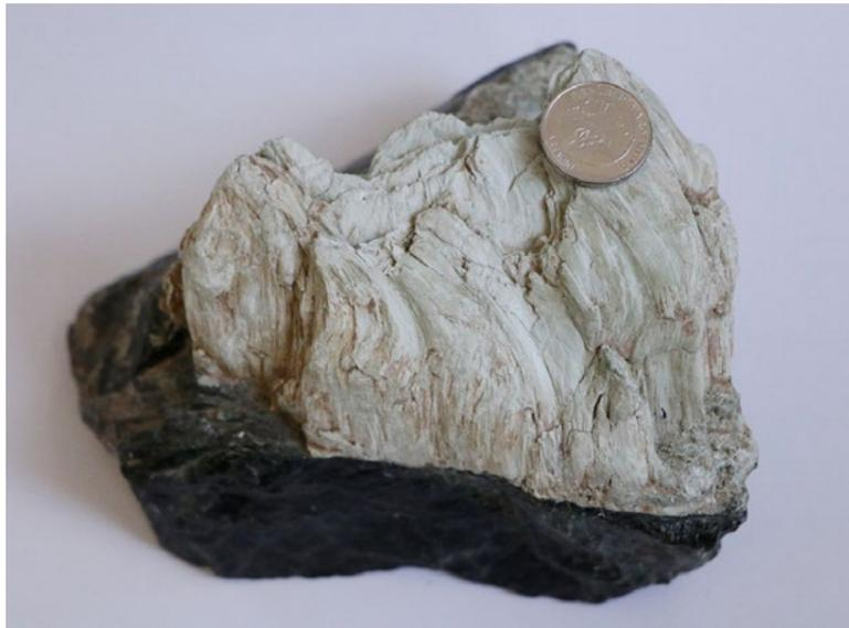
**Figura 71.** Serpentinita de grano fino y color verde oscuro con parte de una vena de crisotilo (mineral serpentínico fibroso de color blanco verdoso y lustre sedoso). Diámetro de la moneda usada como escala 2 cm.
