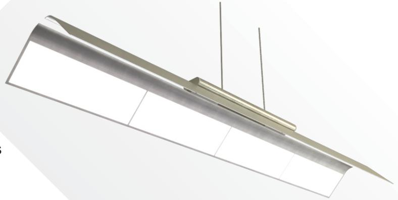
La luminaria está pensada como dos planos (paneles), que con un movimiento de giro simétrico (a un eje central) entre los mismos, cambia de posición y modifica la intensidad y el ángulo de luz emitido.
